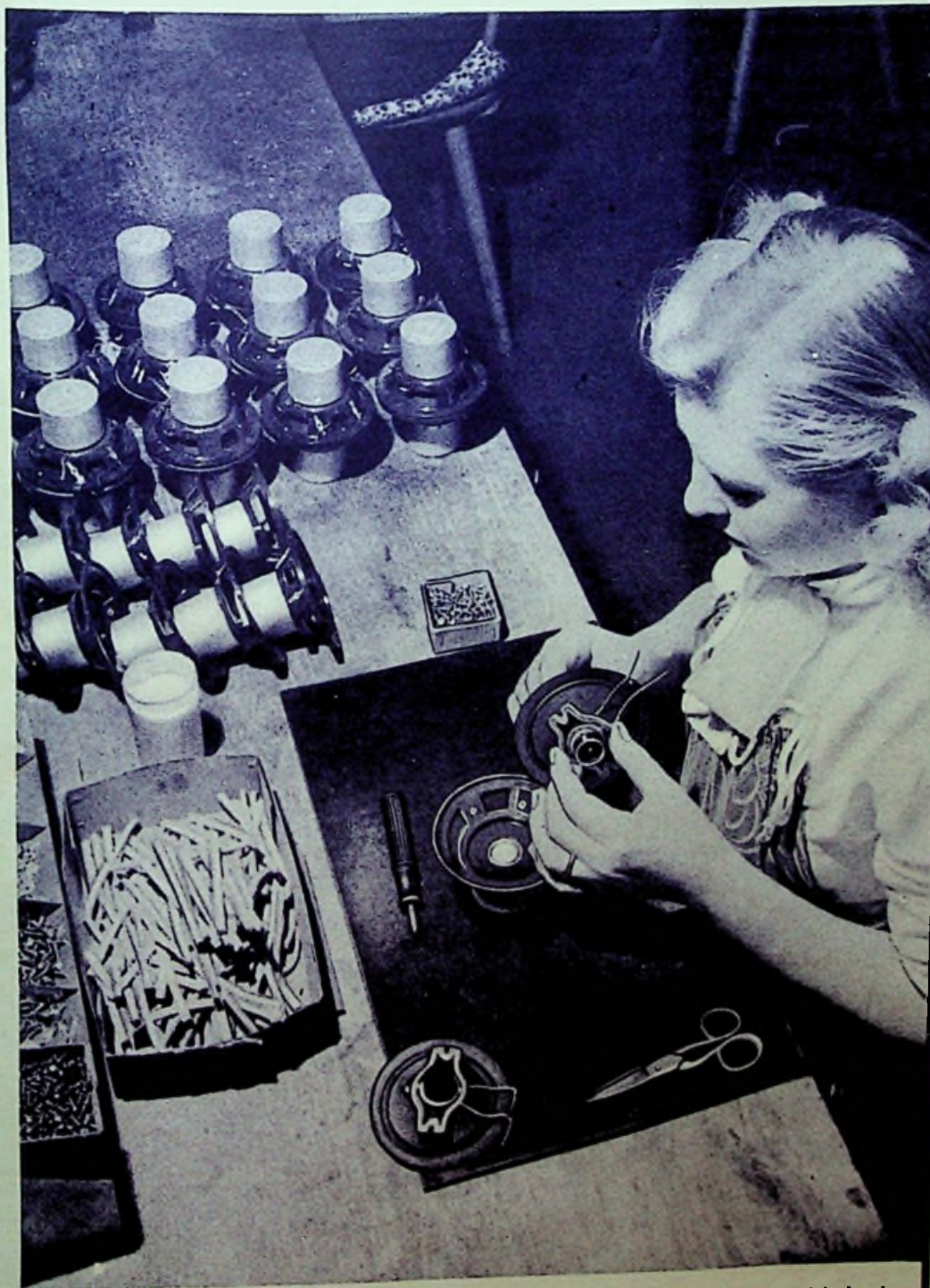
In Reisesuperhets werden hochwirksame permanentdynamische Lautsprecher eingebaut, die sich durch kleine Abmessungen und geringes Gewicht auszeichnen, trotzdem aber ein relativ breites Frequenzband wiederzugeben vermögen. Unser Bild zeigt einen Ausschnitt aus der Lautsprecherfertigung (Einsetzen der Lautsprechermembran mit Zentrierspinne) (Werkfoto: Grundig-Stumpf)
