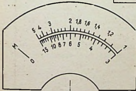
Unten: Bild 129. Skala des Scheinwiderstandsmessers nach Schaltung Bild 128
